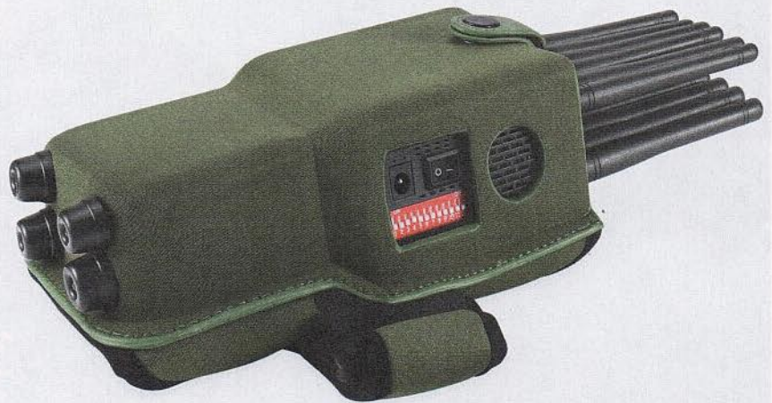
Illegale GPS-Störsender wie dieses in Autos sollen unter anderem die korrekte Erfassung von Mautstellendurchfahrten verhindern.
