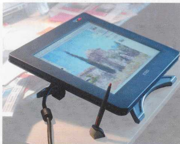
Das Cintiq Tablet kann auf seinem Ständer senkrecht oder schräg stehen (links), um seine Achse gedreht und flach abgesenkt werden (unten); ohne Ständer liegt es etwa auf den Knien.
