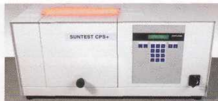
Im Labor: Die Proben werden während der Belichtung intensiv gekühlt.
