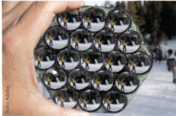
Bei Adobe hat Todor Georgiev eine Lichtfeldkamera konstruiert, die statt Mikrolinsen vor dem Sensor einen Objektivvorschuss mit 19 Linsen nutzt, um aus den Einzelbildern den Verlauf der Lichtstrahlen zu rekonstruieren.
