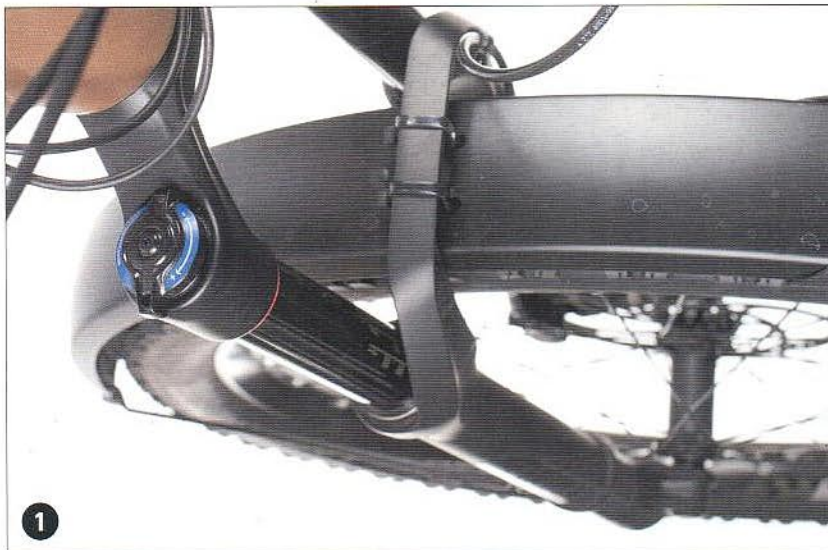
1 Gut einstellbare Luftfedergabel mit 130 Millimeter Federweg: findet sich sonst nur an Mountainbikes
