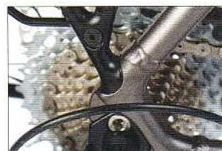
Der Träger von Stevens stützt sich formschlüssig am Rahmen ab. Das bewahrt vor Wackeln und Verbiegen
