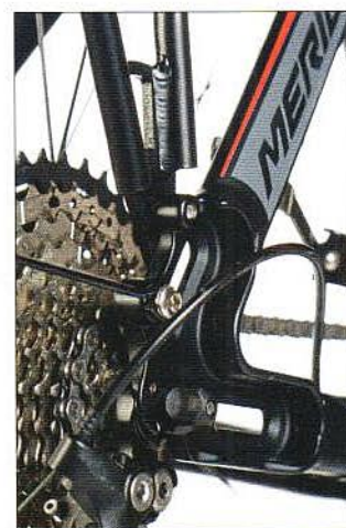
Hier ist der Trägerfuß innen am Rahmen verschraubt. Sieht aufgeräumt aus, kann aber Nachteile mit sich bringen
