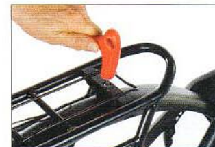
Unter dem Schutzblech verbindet ein U-Profil Gepäckträger und Rahmen. Die Halteschraube dafür muss gut festgezogen sein
