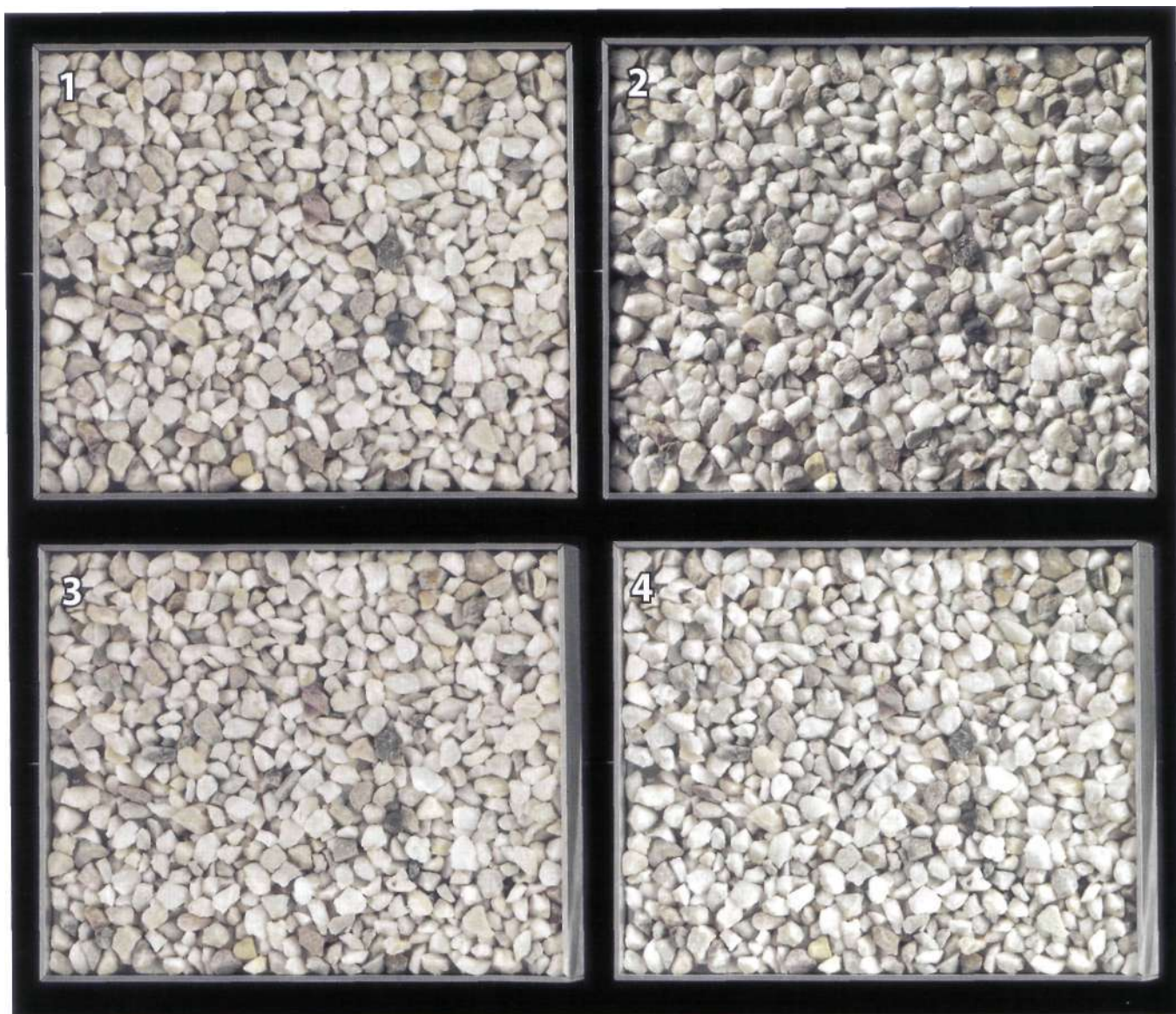
Diese Beispiele demonstrieren neben unterschiedlich zugeschalteten Lichtquellen auch die Schrägansicht: 1: Linke, rechte, untere und obere Lampe eingeschaltet, 2. Linke Lampe plus Lichtablenker, 3. Linke, rechte, obere und untere Lampe, 15° Schrägsicht, 4. Linke Lampe mit Lichtablenker, rechte, 15° Schrägsicht.
