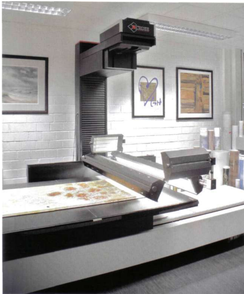
Cruse-Scanner in Aktion; das Gemälde gleitet auf dem Scan-Tisch unter dem Kamerakopf hindurch.
