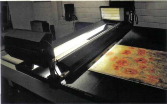
Scan mit Links-rechts-Beleuchtung. Die Lichtquellen sind hier deutlich zu erkennen. Gesteuert werden alle Funktionen über die Software mit Scan-Vorschau.
